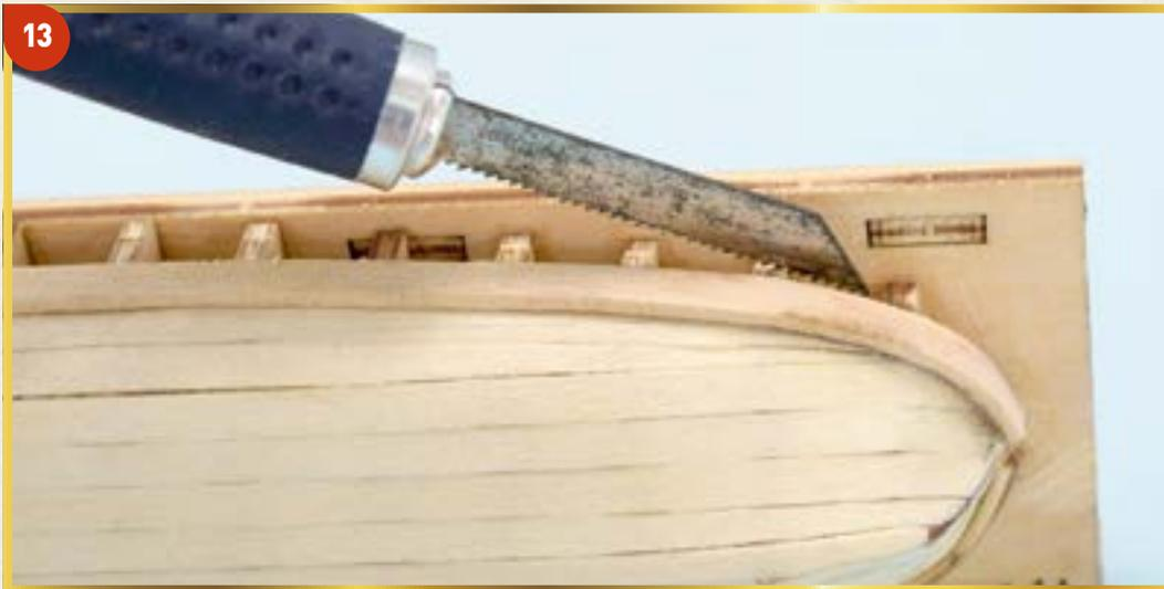
**13** Теперь вам нужно снять корпус шлюпки со стапеля. При помощи тонкой пилки отпилите шпангоуты так, как показано на фотографии. Деталь (17) отпиливать не следует: она не приклеена к стапелю (см. выпуск 5).
