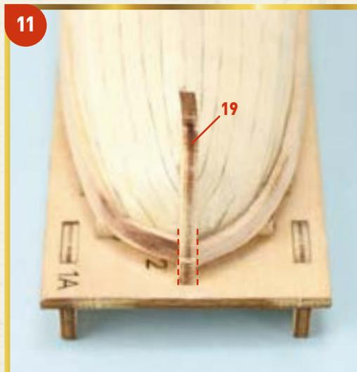
**11** Возьмите форштевень (19), полученный с выпуском 5 вместе с остальными деталями для шлюпки. Приложите его к носовой части шлюпки на осевой линии и сделайте на планках, с которыми вы работали в шагах 8 и 9, карандашом две отметки, соответствующие краям форштевня.
