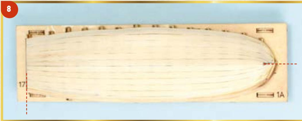
**8** Теперь перейдем к работе над шлюпкой. Обрежьте заднюю часть планки, которую вы приклеили, следуя инструкциям выпуска 7, вровень с транцем (17), а переднюю ее часть — по осевой линии.
