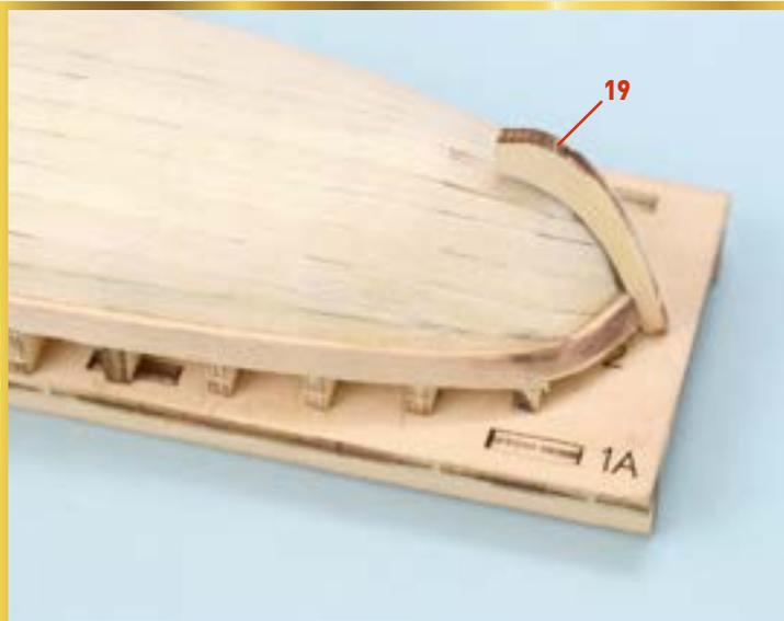
**12** С помощью модельного ножа вырежьте отмеченную вами часть планок. Затем надфилем обработайте получившийся паз, чтобы деталь (19) могла войти в него.
