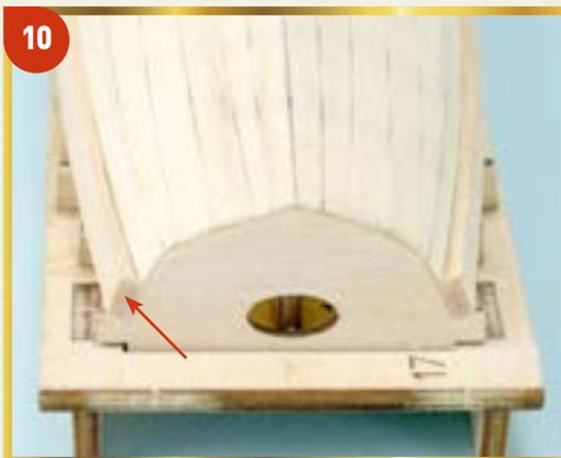
**10** После высыхания клея обрежьте заднюю часть планки вровень с транцем (17) шлюпки.
